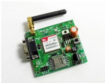
Fig.3. Gsm Module
