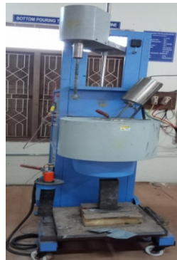
Fig 3. Bottom pouring type stir casting machine
